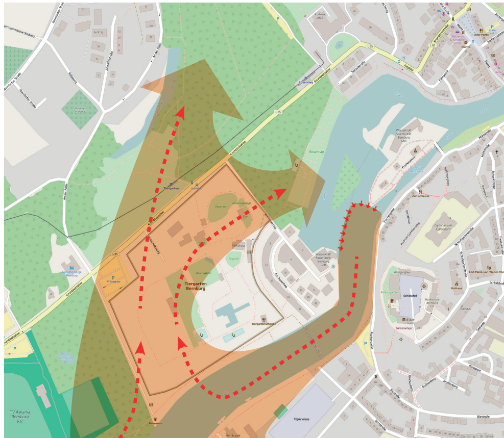
Bild 23: Nach der Saaleflut 2013: Erosion als Folge starker Strömung vom Ober- in den Unterlauf im Bereich des Zugangs zum Bernburger Rosenhag.
